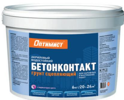
Специальная адгезионная грунтовка с кварцевым наполнителем обладает высокой сцепляющей способностью, применяется для предварительной обработки бетона, бетонных блоков, изделий из гипсобетона, плотных минеральных оснований перед нанесением гипсовых и цементных выравнивающих штукатурок, латексных шпатлевок, клея для плитки. Увеличивает сцепление шпатлевок, штукатурок и плиток к основанию. Не содержит органических растворителей. Эффективна на невпитывающих поверхностях.
